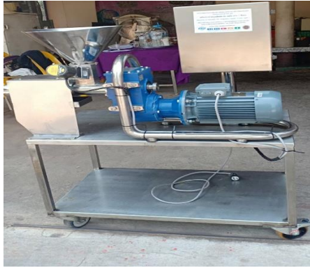
ภาพที่ 5 เครื่องบีบน้ำมันเมล็ดพืช ผัก ผลไม้ ติดตั้งสถานที่จริง
